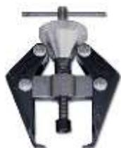
Ermöglicht die einfache Entfernung von Wischerarmen. Auch geeignet zum Entfernen von korrodierten und festsitzenden Batteriepolen, Getrieben oder Kupplungen von kleinen Elektromotoren. Abziehweg ca. 25 mm.
