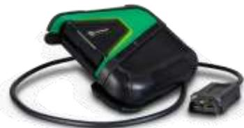
Das robuste Gehäuse des mega macs X umfasst die gesamte Logik, den Prozessor, die Diagnosesoftware und die integrierten Diagnoseprotokolle - unter anderem CAN FD und DoIP für neue Fahrzeugmodelle wie Skoda Octavia, Volvo XC 90 und Golf 8 von Volkswagen. Welches Anzeige- und Bediengerät Sie für die Fahrzeugdiagnose nutzen wollen, bleibt Ihnen überlassen: Egal, ob es sich um ein Tablet, ein Notebook oder einen PC mit einem der gängigen Betriebssysteme (Windows, Android, Apple IOS, Linux) handelt.
